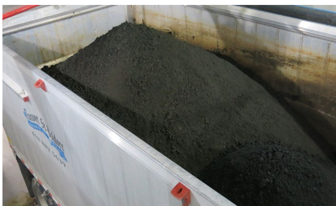
Biosolides issus de la STEU à Repentigny.
