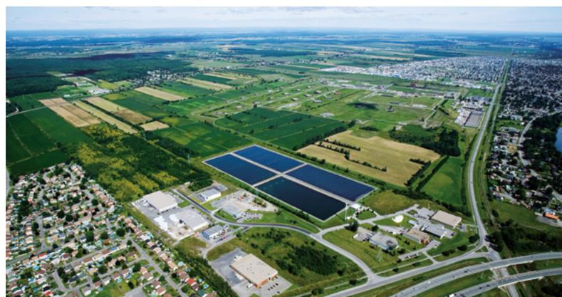
**Au Québec, les étangs aérés représentent la technologie la plus largement répandue pour traiter les eaux usées municipales. Par conséquent, il s'avère essentiel que de bonnes pratiques de gestion et d'exploitation y soient appliquées, tant d'un point de vue environnemental que sur le plan de la saine gestion municipale. La protection des lacs et des cours d'eau du territoire québécois en dépend grandement!**
