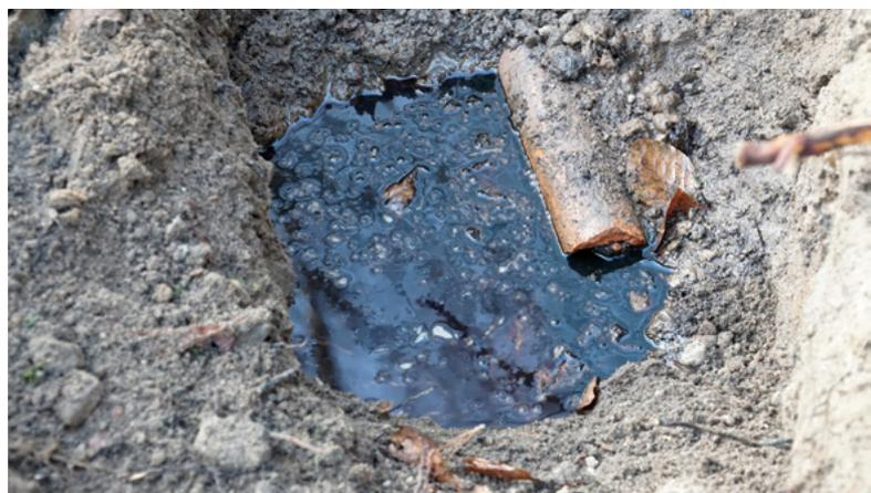
**Outre les réservoirs actifs, il existe au Canada un nombre important d'équipements (réservoirs et tuyauterie) dits « historiques » qui, bien qu'ils ne soient plus utilisés depuis longtemps, sont restés en place. Parfois encore remplis d'huile, certains d'entre eux fuient et contaminent les sols et les eaux souterraines. Voici une étude de cas d'une réhabilitation combinant l'excavation et le traitement in situ!**
