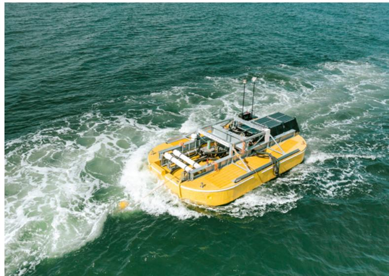
dessalement exploitant exclusivement l'énergie renouvelable des vagues de l'océan pour transformer l'eau de mer en eau douce; celles-ci ne nécessitent aucune source d'électricité externe. L'énergie des vagues est la plus dense sur Terre, bien plus constante et prévisible que l'énergie solaire ou éolienne.
