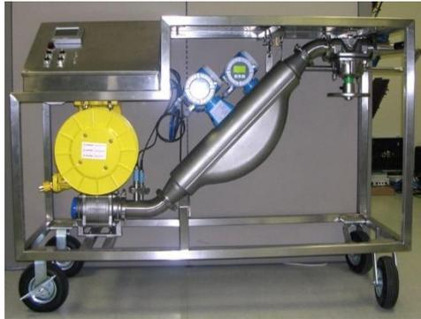
Figure 33. Exemple d'un ensemble utilisé par Endress+Hauser Canada pour la vérification et la certification des débitmètres dans l'industrie
